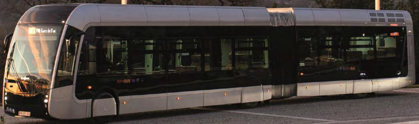
**1<sup>er</sup> bus au monde de 18m de long à l'hydrogène**
