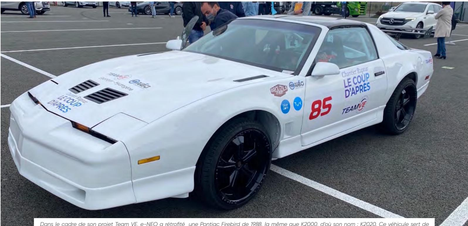
Dans le cadre de son projet Team VE, e-NEO a rétrofité une Pontiac Firebird de 1988, la même que K2000, d'où son nom : K2020. Ce véhicule sert de support de communication mais aussi de base de développement avec l'ajout en 2021 d'une pile à combustible alimentée par de l'hydrogène vert produit en Vendée, montée comme un prolongateur d'autonomie.
