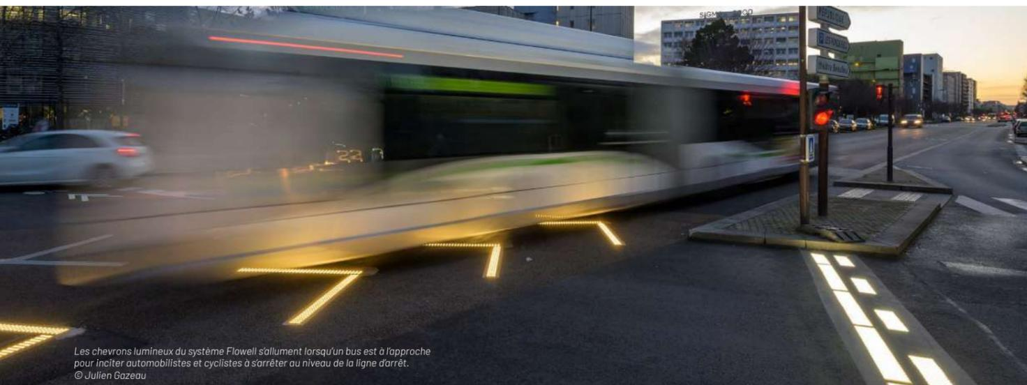
Les chevrons lumineux du système Flowell s'allument lorsqu'un bus est à l'approche pour inciter automobilistes et cyclistes à s'arrêter au niveau de la ligne d'arrêt.
