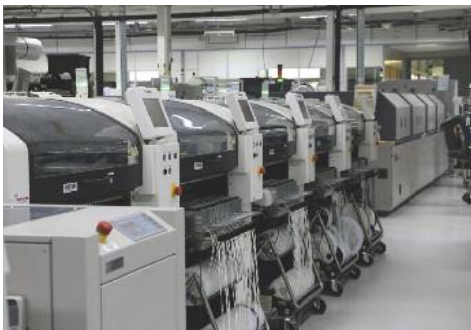
Ligne de CMS (composants montés en surface) à l'usine Actia de Colomiers.
